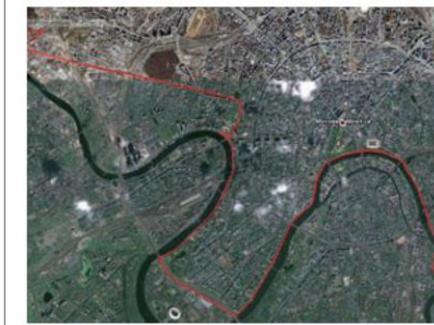
Рисунок 3 Испытания РАВИС в Москве: мощность передатчика ~1 кВт, модуляция 16-QAM, стабильный прием при MER от ~14 дБ
