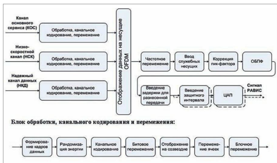
Рисунок 1 Структурная схема передающей части РАВИС
