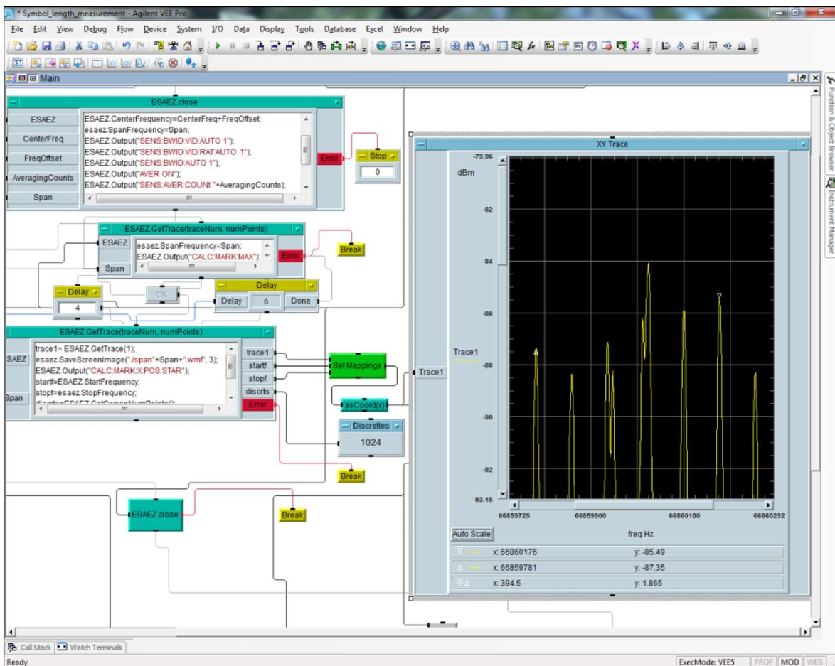
Рисунок 9. VEE Pro. Измерение длительности пяти последовательных символов РАВИС
