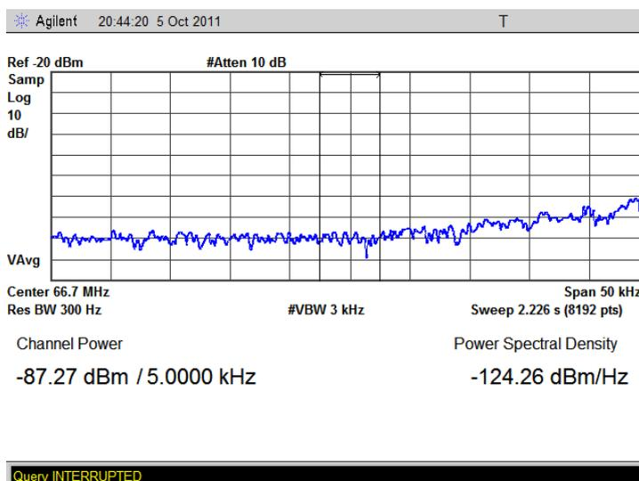
Рисунок 21. Плотность мощности минус 124,3 дБм/Гц на частоте  $f_{(0-160)}$
