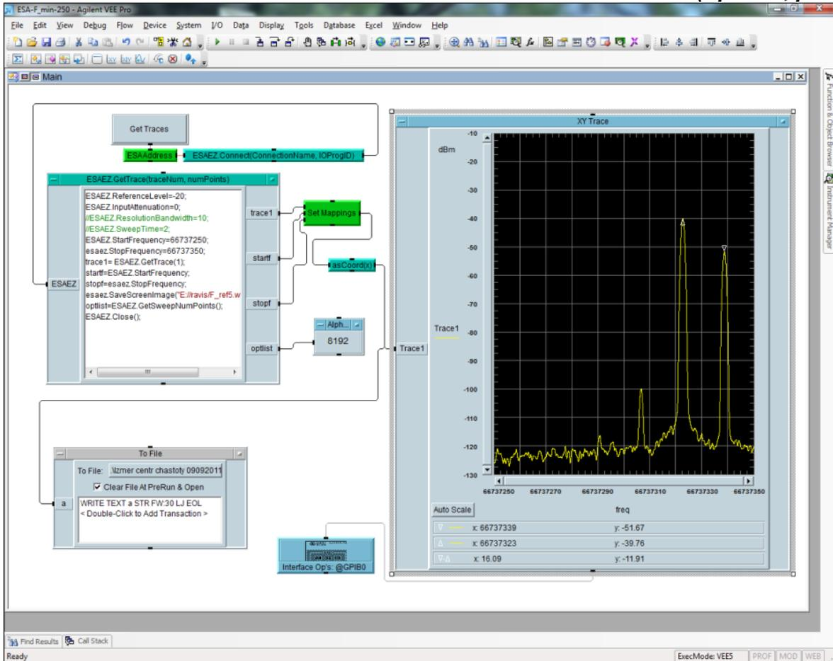
Рисунок 4. VEE Pro. Результаты измерений частот  $f_{(-276)}$  и  $f_{(-276)-20}$  и их разности
