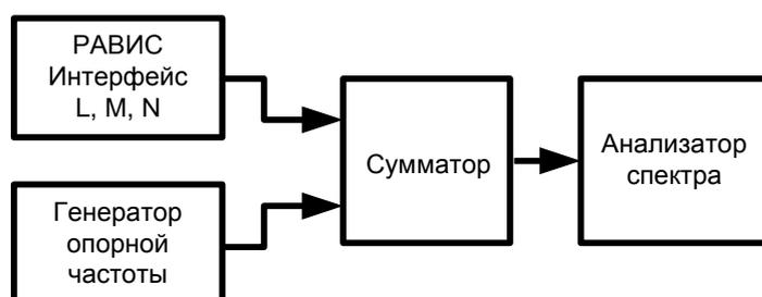
Рисунок 3. Схема измерения точности настройки по РЧ
