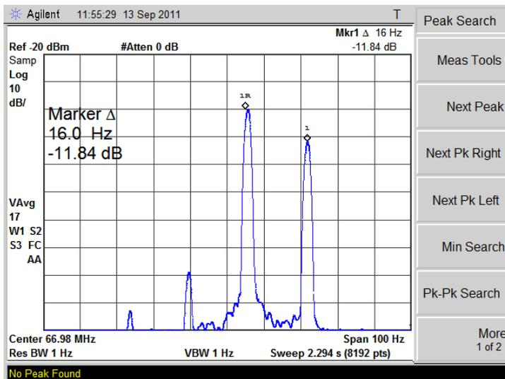
Рисунок 5. Agilent E440B. Результат измерений разности частот  $f_{(276)}$  и  $f_{(276)-20}$
