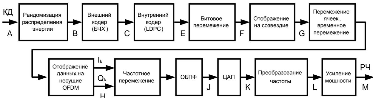
Рисунок 1. Функциональная схема передающей части системы РАВИС (передатчик)
