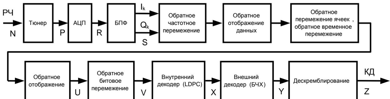
Рисунок 2. Функциональная схема приемной части системы РАВИС (приемник)
