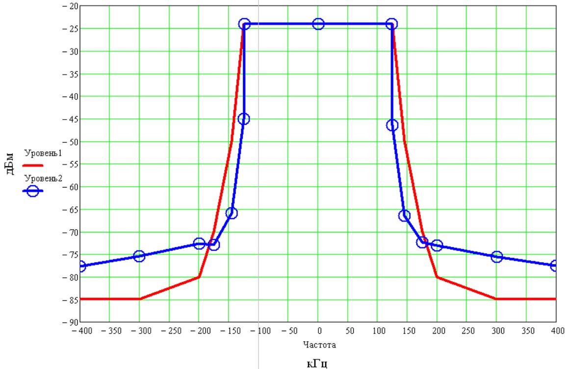
Рисунок 10. Плотность спектра ПЧ и РЧ сигнала РАВИС в полосе 250 кГц
