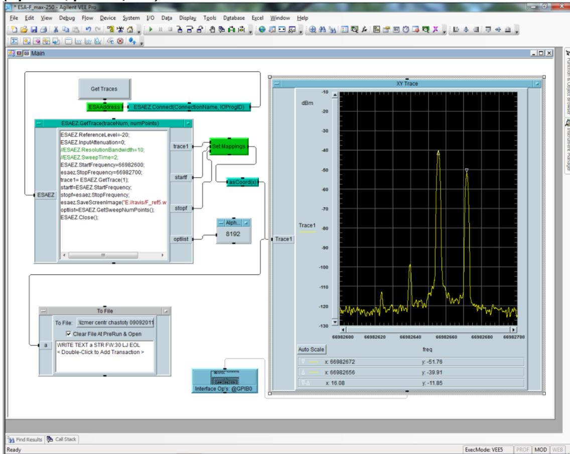
Рисунок 6. VEE Pro. Результаты измерений частот  $f_{(276)}$  и  $f_{(276)-20}$  и их разности
