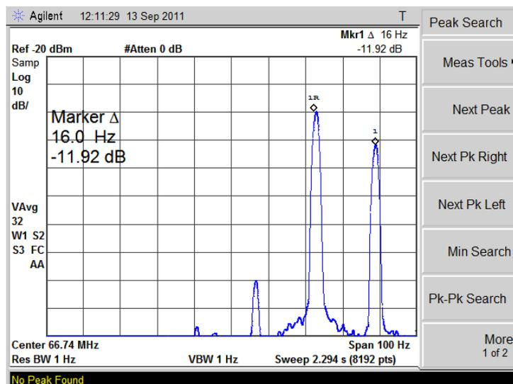
Рисунок 3. Agilent E440B. Результат измерений разности частот  $f_{(-276)}$  и  $f_{(-276)-20}$
