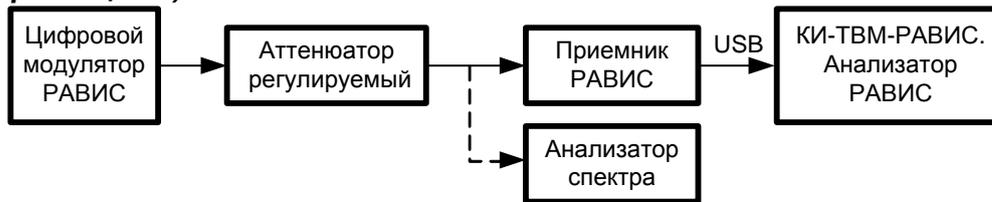
Рисунок 4. Схема измерения чувствительности и динамического диапазона
