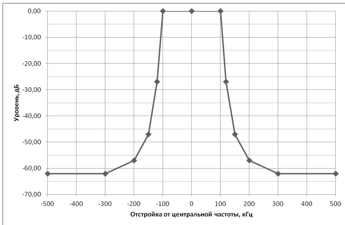
Рисунок 2 – Маска огибающей внеполосных радиоколечаний для условной ширины полосы частот 200 кГц
