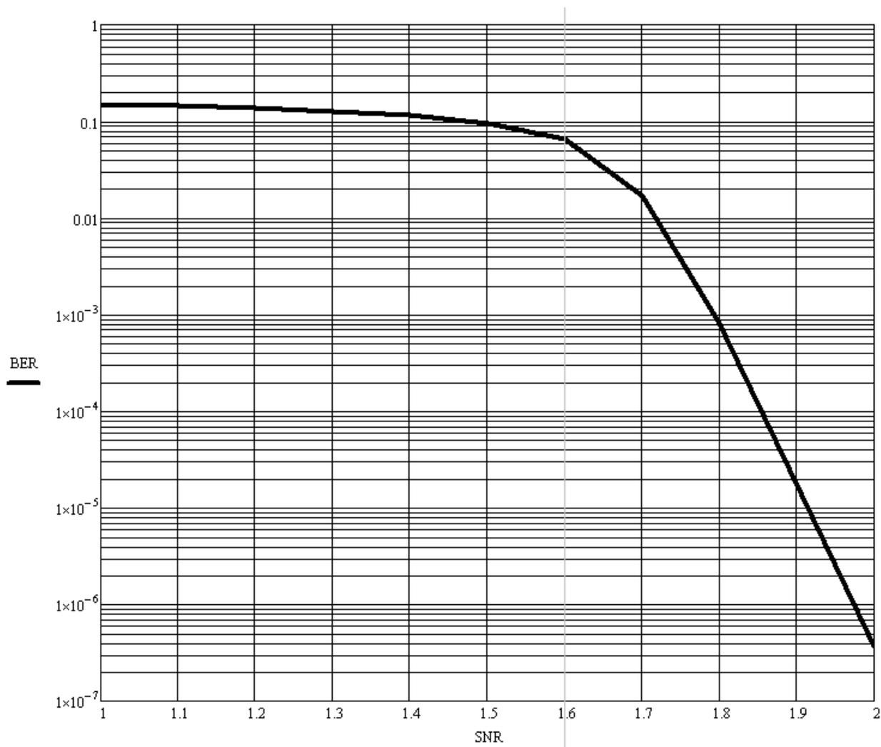
Рисунок 1 - График зависимости BER от ОСШ
