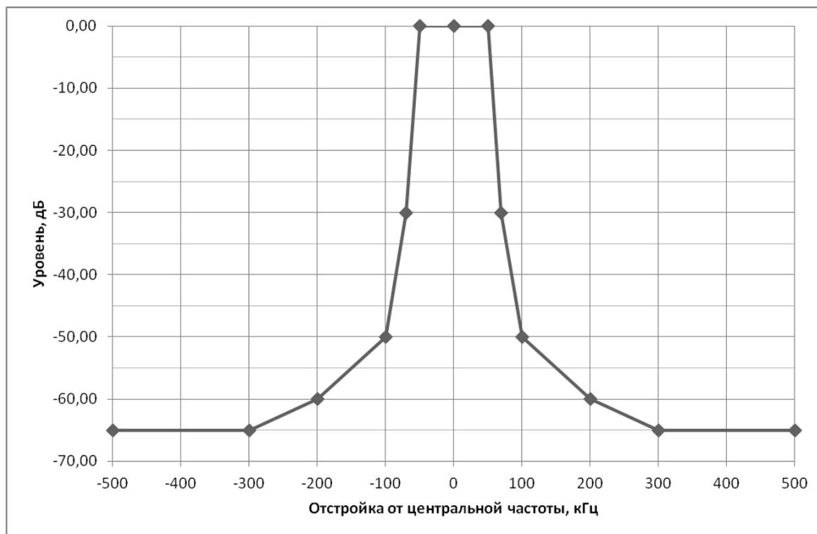
Рисунок 1 – Маска огибающей внеполосных радиоколечаний для условной ширины полосы частот 100 кГц
