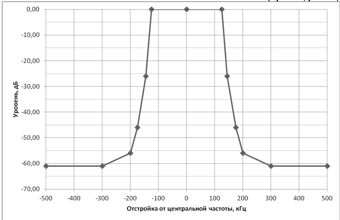
Рисунок 3 – Маска огибающей внеполосных радиоколечаний для условной ширины полосы частот 250 кГц
