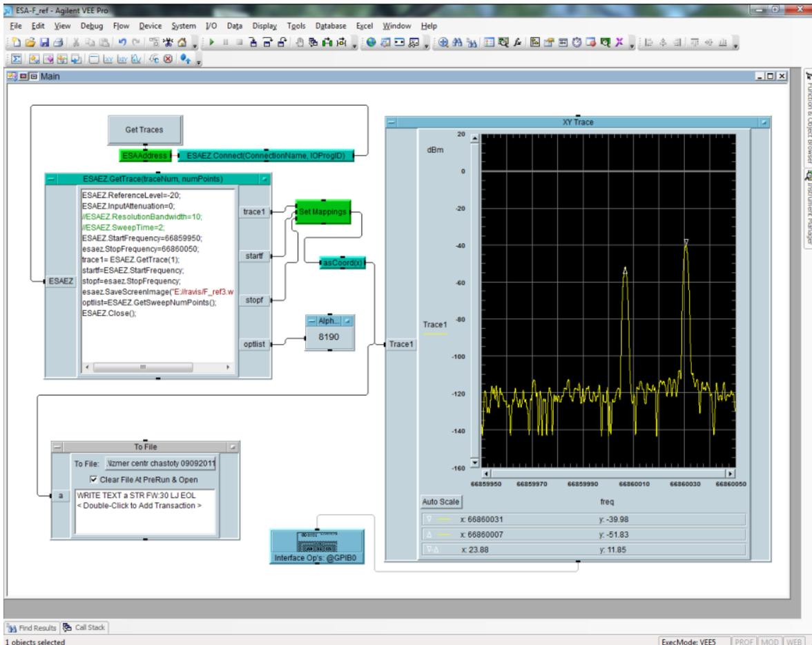
Рисунок 2. VEE Pro. Результаты измерений частот  $f_{(0)}$  и  $f_{(0)+20}$  и их разности
