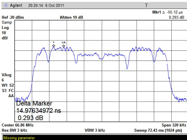
Рисунок 7. Спектр ИС «РПН» в полосе сканирования (Span) 320 кГц
