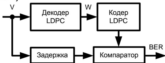
Рисунок 6. Измерение BER до канального декодера LDPC
