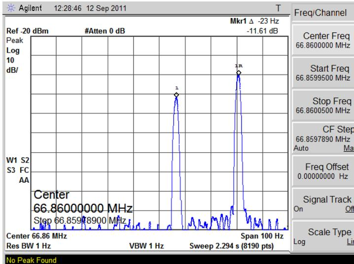
Рисунок 1. Agilent E440B. Результат измерений разности частот  $f_{(0)}$  и  $f_{(0)+20}$
